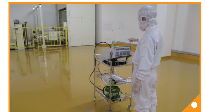
Đo kiểm cấp độ sạch cho Phòng sạch ROOM CLEANLINESS CHECK
