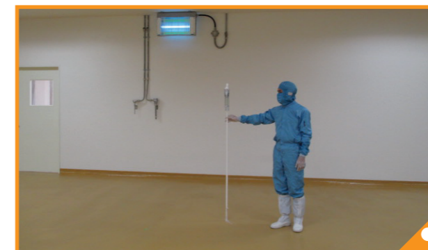
Đo kiểm Nhiệt độ Độ ẩm Phòng sạch ROOM TE HE CHECK
